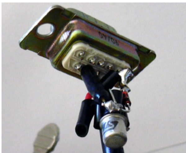
Figura 8 : Particolare delle saldature e dell'isolamento dei terminali nel connettore seriale
