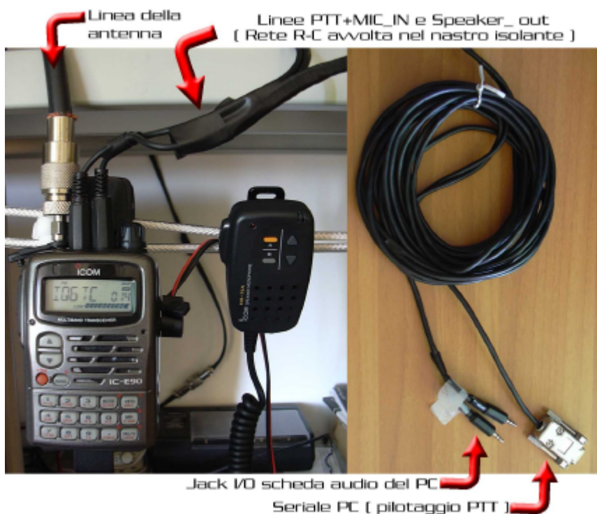
Figura 7 : Foto del prototipo di tipo hand-held realizzato con seriale DB9
